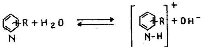
equilibrio que nos produce el consiguiente aumento del pH del sistema y, por tanto, una mayor facilidad para la captación de las moléculas de SO<sub>2</sub>, o de los iones SO<sub>3</sub>H<sup>-</sup> producidos a partir de ellas.
