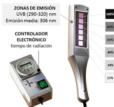
Figura 4B.5. Simulador solar Dermalight® 80 MED tester PUVB.
