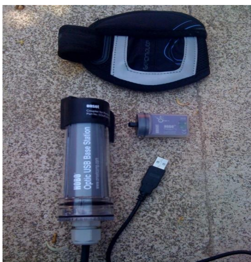
Figura 4. En la imagen se puede observar la banda deportiva (parte superior) dentro de la cual se colocó el sensor Hobo pendant G®Acceleration Data Logger (parte derecha de la imagen). Los datos se descargaron al ordenador personal mediante una base óptica USB (izquierda de la imagen)
