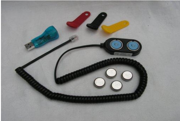
Figura 5. Sensores de temperatura inalámbricos ((Thermochron® iButton Data loggers DS1921H#F50, IDC SA, España) junto a una de las bases de descarga y el adaptador USB.
