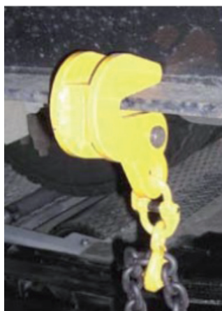
Figura 10: Simulación tirando del ala del bastidor
