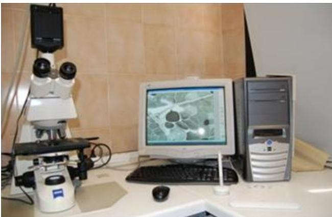
**Figura 16.** Imagen del microscopio (“Axioskop” 40) y cámara “Spot insight QE”) utilizados para la obtención de las microfotografías
