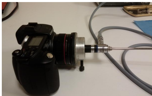
Figura 10. Cámara Canon Power Shot Pro 1 con el adaptador para fijación de ópticas
