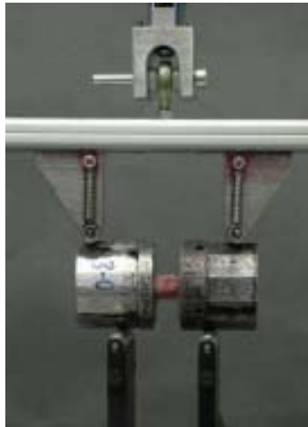
Figura 32: Configuración de la muestra para la realización del ensayo de flexión.
