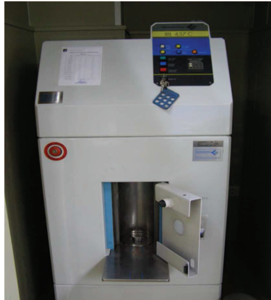
Fig. 9 Irradiador celular gamma IBL 437C con fuente de radiación \text{Cs}^{137}
