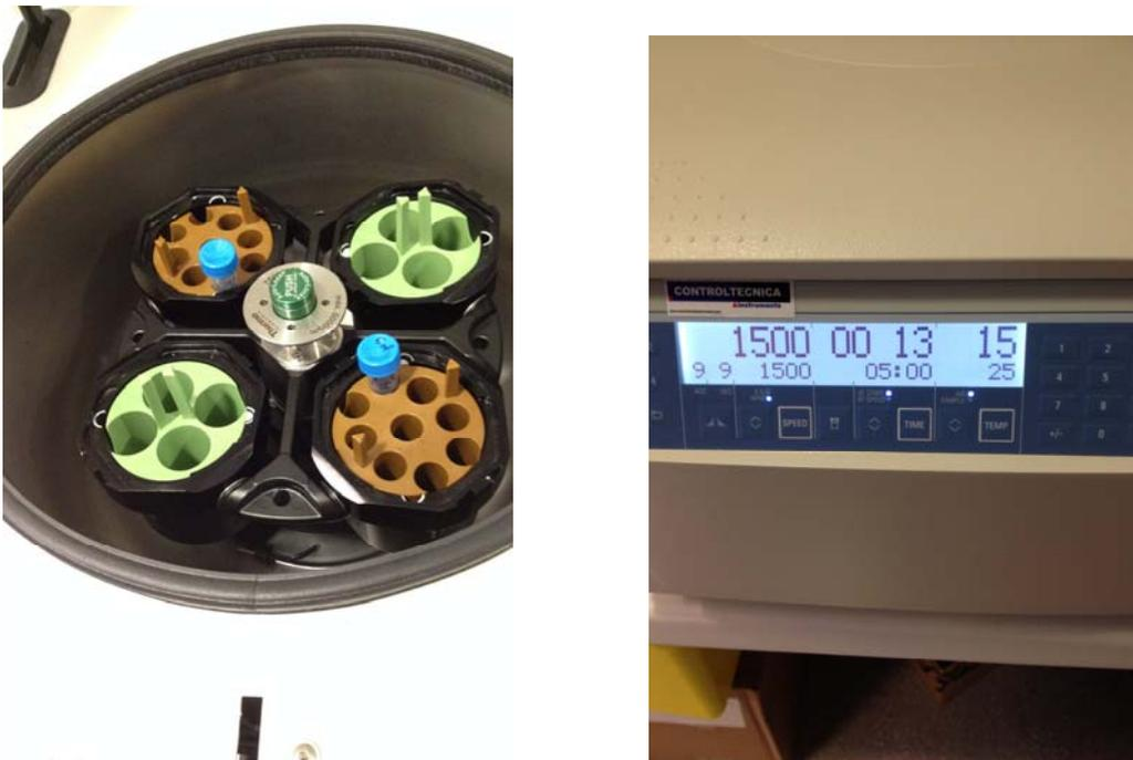
Figura 7. Imagen de la centrifugadora a 1500 rpm para la obtención del pellet celular.
