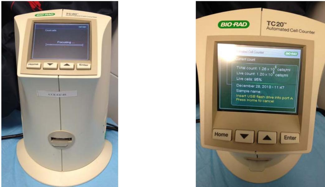
Figura 9. Lector automático *TC20<sup>TM</sup> Automatic Cell Counter* de BioRad con la que se realizó el recuento y estimación de la viabilidad celular.
