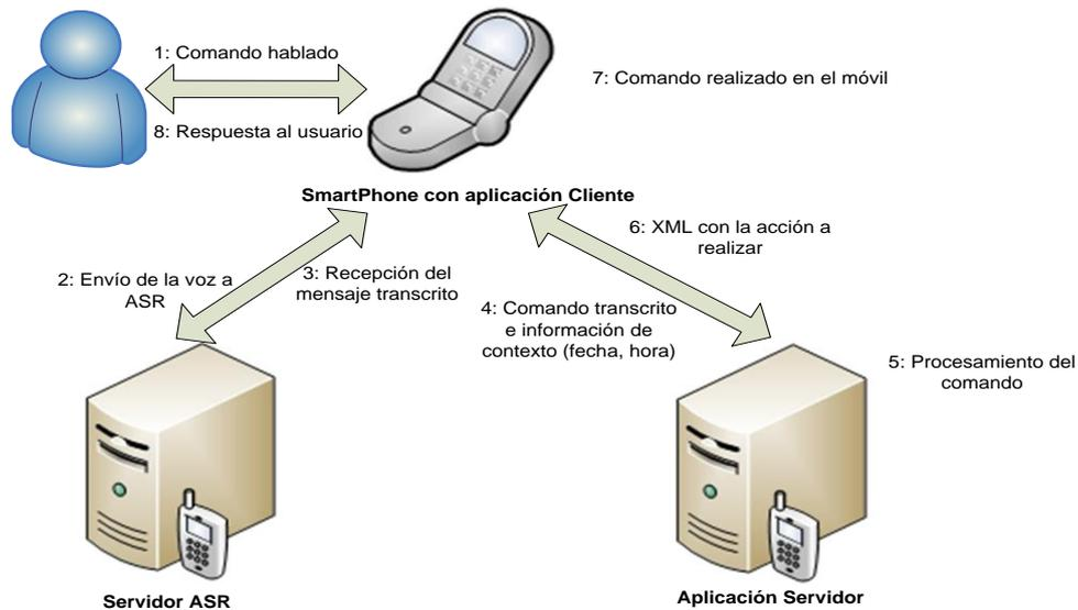
**Figura 19. Diseño global del sistema propuesto.**
