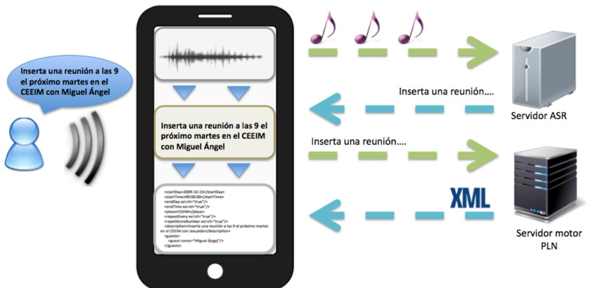
Figura 52. Funcionamiento del módulo de conexión servicio
