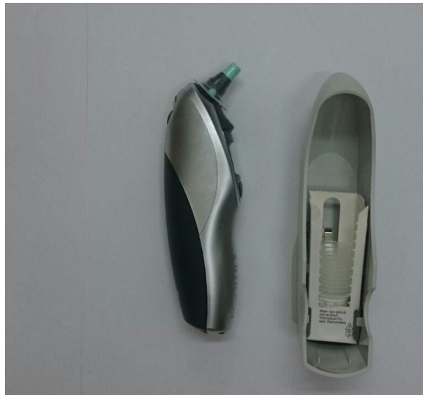
Figura 32. Termómetro de oído Braun ThermoScan PRO 4000 y protectores de sondas de un solo uso.
