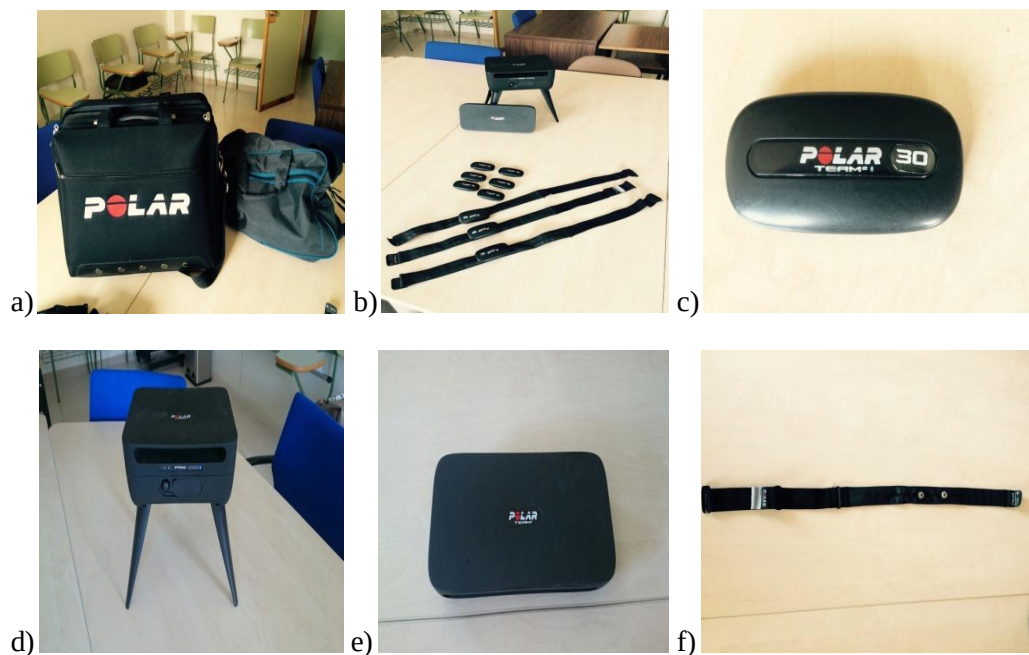
Figura 33. Equipo de monitorización de frecuencia cardíaca POLAR TEAM2 (Polar Electro®, Kempele, Finland). a) bolsa de transporte; b) equipo completo; c) transmisor; d) unidad central; e) cargador; f) cinta pectoral.
