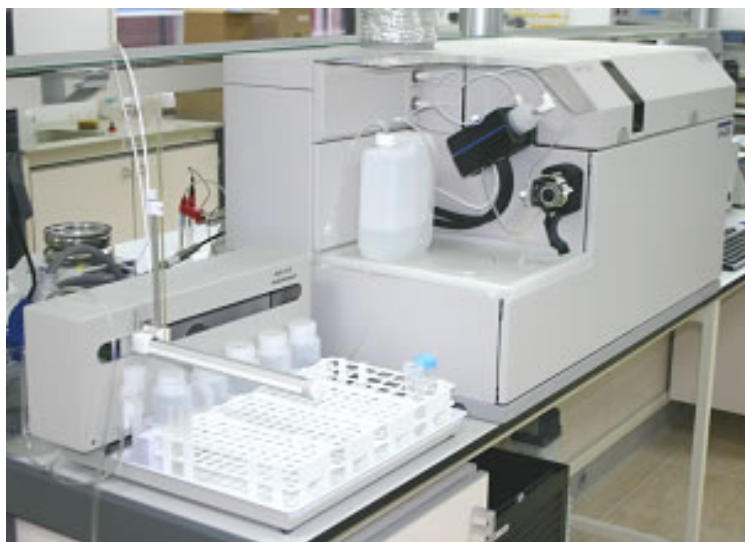
Figura 3. Espectrómetro de masas con plasma acoplado inductivamente (ICP-MS) en el equipo “ICP-MS Agilent 7500 a ”.
