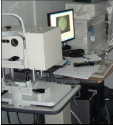
*Fig 23. Aberrómetro de HS diseñado por LOUM*
