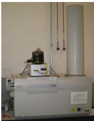
**Figura 3.26.** Espectrofotómetro de masas MSD TOF de Agilent Technologies.
