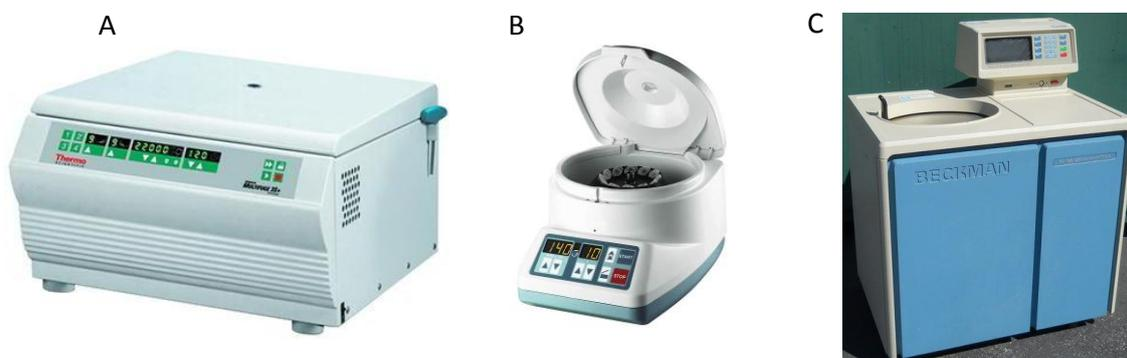
**Figura 3.21.** (A) Centrífuga Heraeus Multifuge 1L-R, utilizada para la sedimentación de células y de placas de ensayo tipo ELISA. (B) Microfuga Hettich mikro 120, utilizada para la obtención de pellets de células, la extracción de ácidos nucleicos y la inmunoprecipitación de proteínas. (C) Ultracentrífuga Beckman XL-90, utilizada para la centrifugación en gradiente discontinuo de sacarosa para la purificación de melanosomas.
