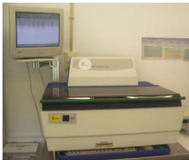
**Figura 3.44.** Contador de centelleo beta Wallac Winspectral 1414.
