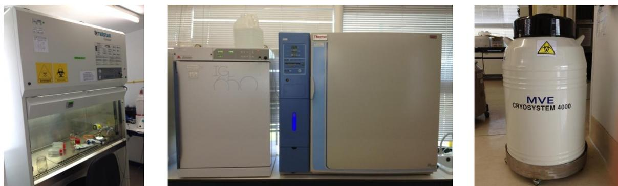
**Figura 3.1.** Cabina Cytostar de flujo laminar vertical de seguridad biológica y química de clase II de Telstar (panel izquierdo). Incubadores de CO<sub>2</sub> IG650 de Jouan y Steri-Cult 3310 de Thermo Scientific (panel central). Depósito de nitrógeno líquido MVE Cryo System 4000 de Cryo Solutions LS3000 (panel derecho).
