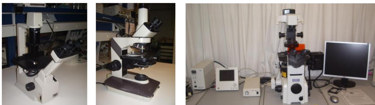
**Figura 3.11.** Microscopio invertido TMS de Nikon (panel izquierdo), microscopio LABOPHOT-2 de Nikon (panel central) y microscopio invertido ECLIPSE TE200-U (panel derecho).
