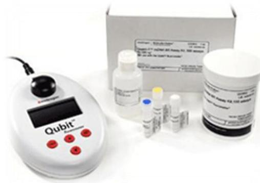
Figura 3.35. Plataforma Qubit™ para la cuantificación de ARN, ADN y proteínas.
