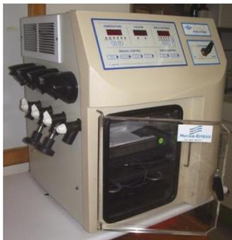
Figura 3.24. Liofilizador Virtis Advantage 2.0 ES.
