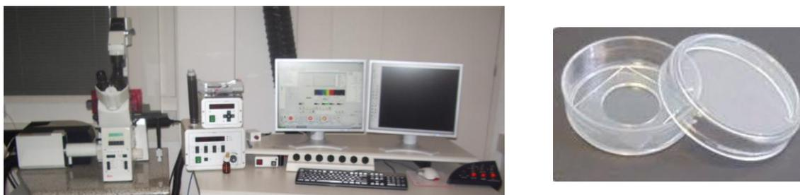
**Figura 3.12.** Microscopio confocal Leica TCS-SP2 (panel izquierdo). Placas *Glass Bottom Dishes* empleadas para la visualización de células vivas (panel derecho).
