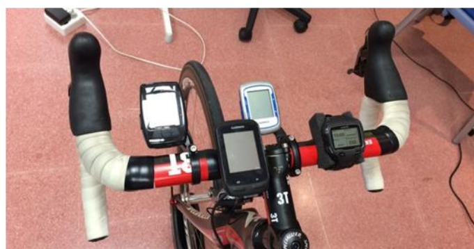
Ilustración 31. De izquierda a derecha. Joule GPS, Garmin Edge 800, Garmin Edge 500 y Garmin Foreruner 910 xt.
