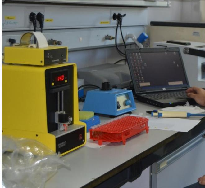
**Figura 15.** Osmómetro Roebling utilizado para el análisis del potencial osmótico.
