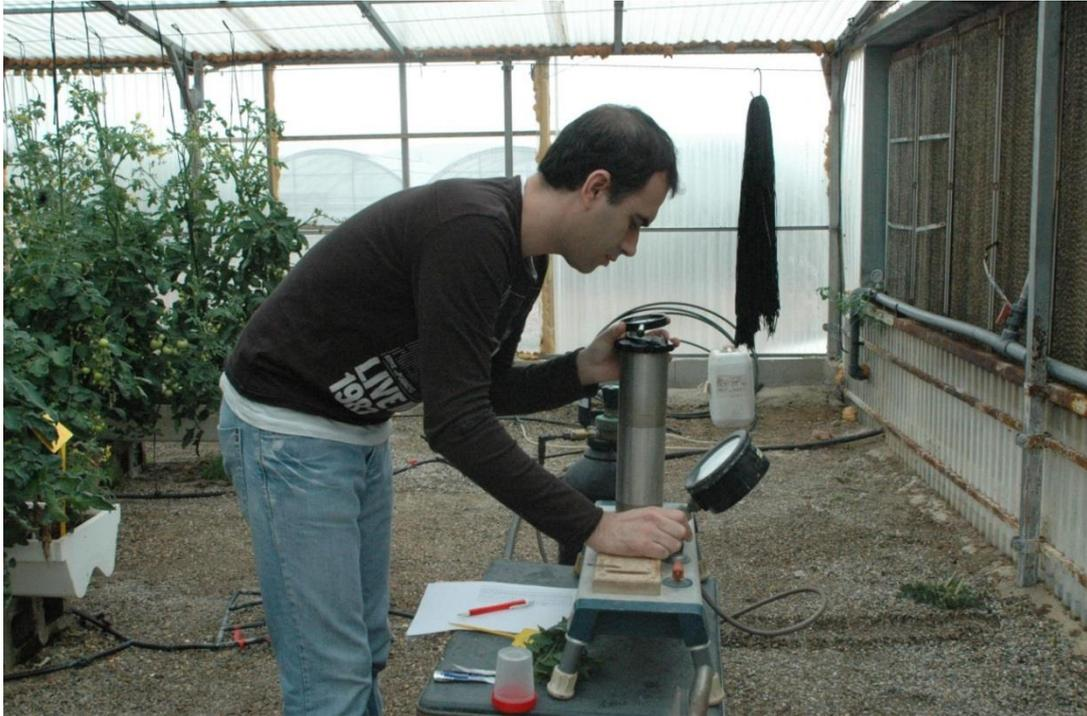
**Figura 14.** Imagen de la toma de medidas de potencial hídrico con cámara de presión tipo Scholander.
