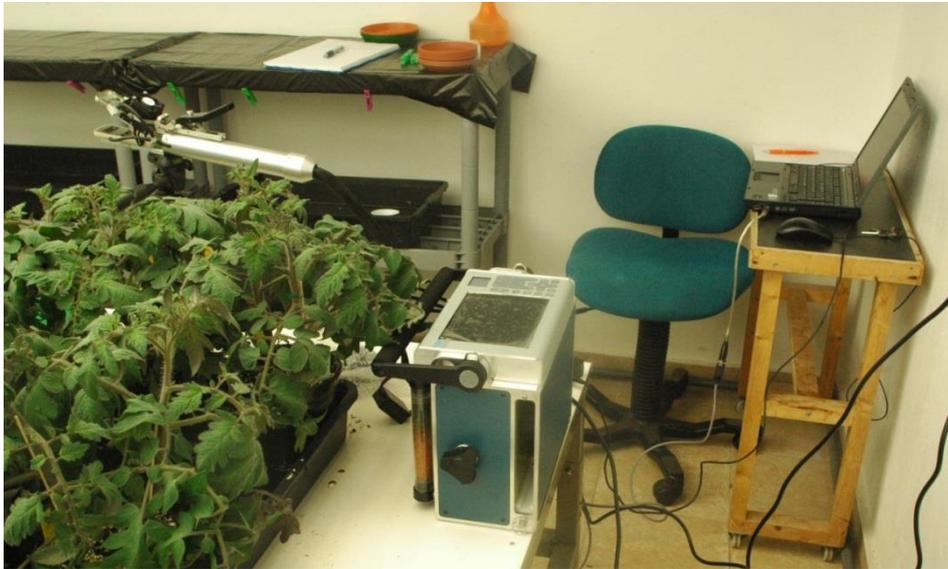
**Figura 16.** Fotografía de medidor portátil de intercambio gaseoso CYRAS-2 utilizado en este trabajo de tesis Doctoral.
