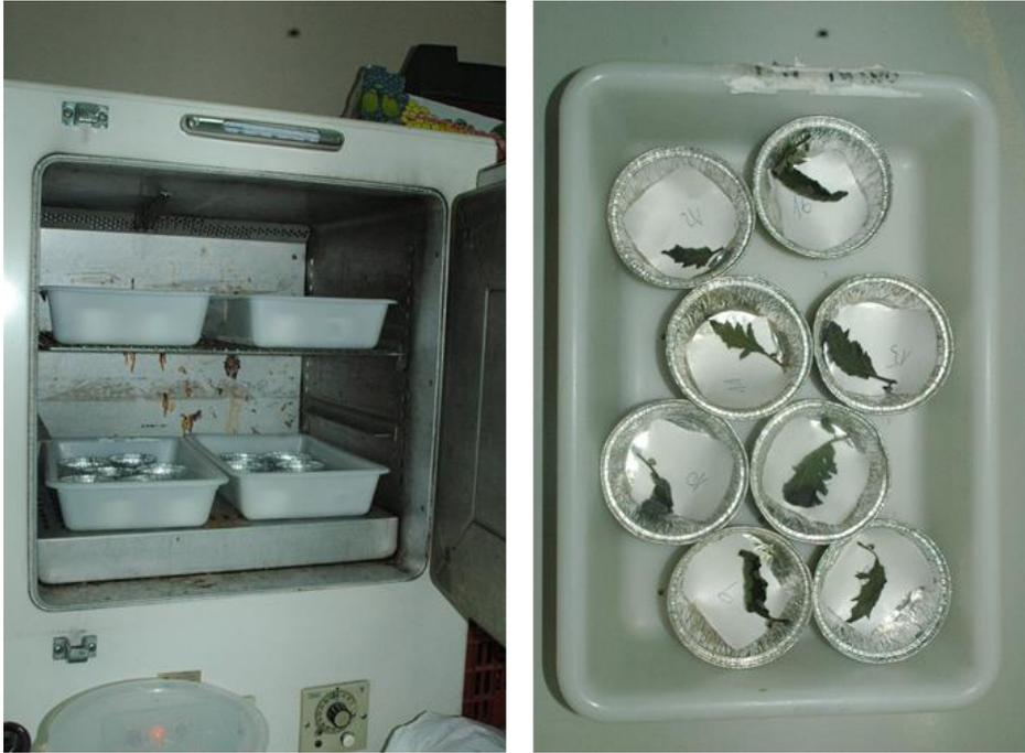
**Figura 13.** Estufa usada para el secado de las muestras y material vegetal seco para la determinación de contenido de agua.
