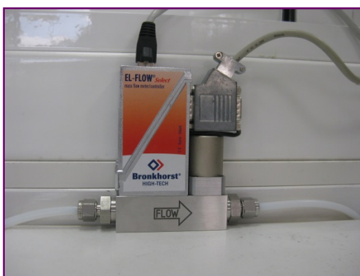
Figura IV.1.1.5.2 - Controlador-medidor másico BRONKHORST HIGH-TECH 201DV-AAD-33-E, utilizado para incorporar benceno a la matriz de aire o nitrógeno.
