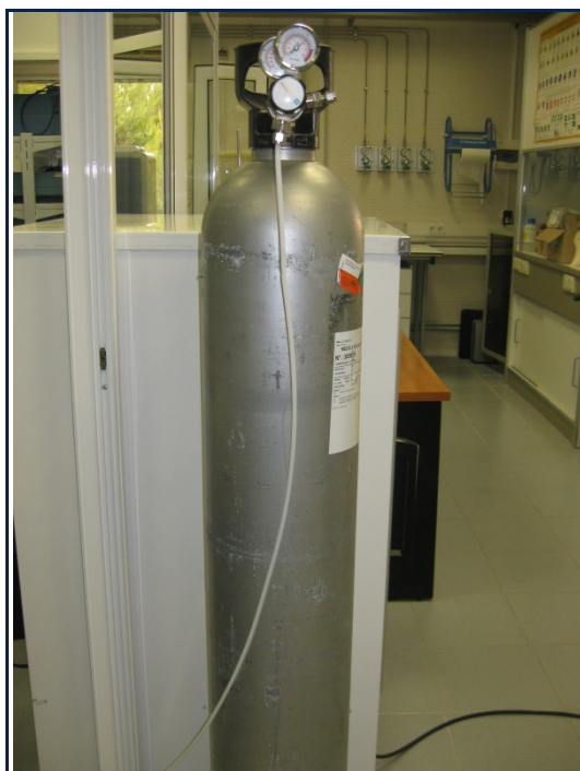
Figura IV.1.1.6.1 - Botella de gas a presión conteniendo una mezcla de benceno en nitrógeno.
