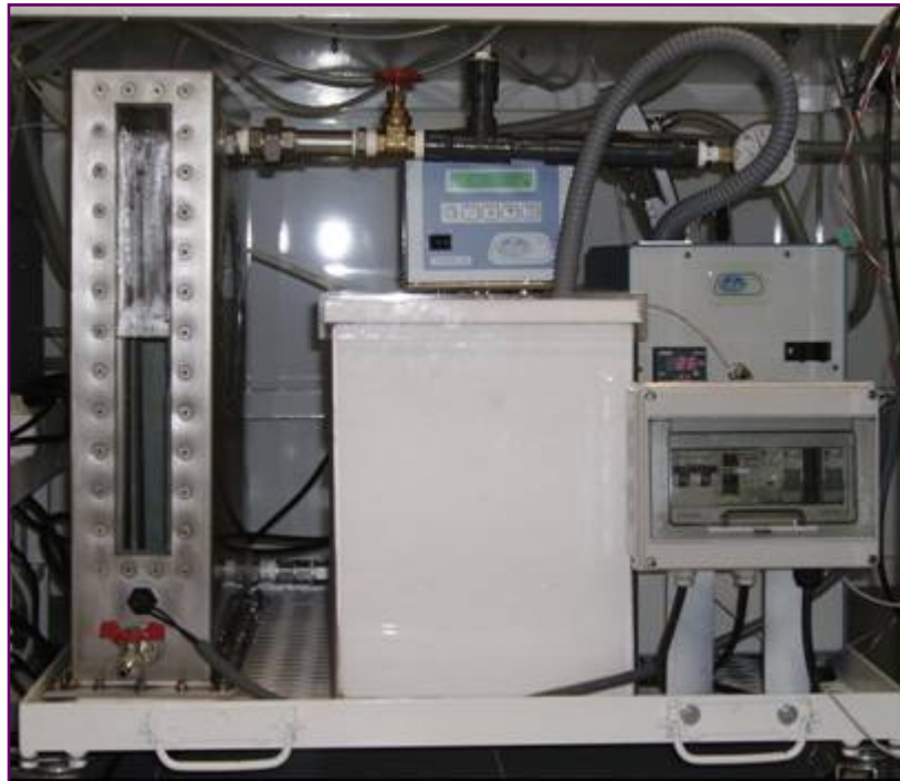
Figura IV.1.1.4.3 - Baño termostático para el acondicionamiento del agua destilada de humidificación.
