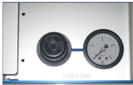
Figura IV.1.3.3.4 – Vista detallada del sensor de presión (medidor de presión y válvula de regulación) del gas portador (nitrógeno).
