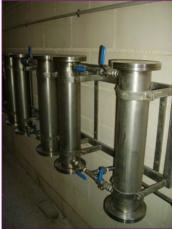
Figura IV.1.1.2.1 - Detalle de los seis cilindros de acero inoxidable del sistema de purificación del aire matriz fabricados en el Taller Mecánico del SACE de la Universidad de Murcia.
