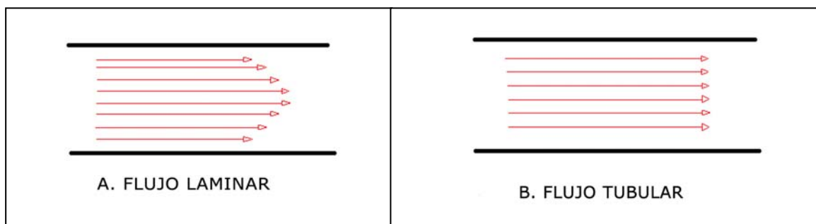
Figura 3. Representación de los patrones de flujo sanguíneo: A. En el flujo laminar, las mayores velocidades están en el centro del vaso; B. En el flujo tubular, todas las velocidades son iguales.
