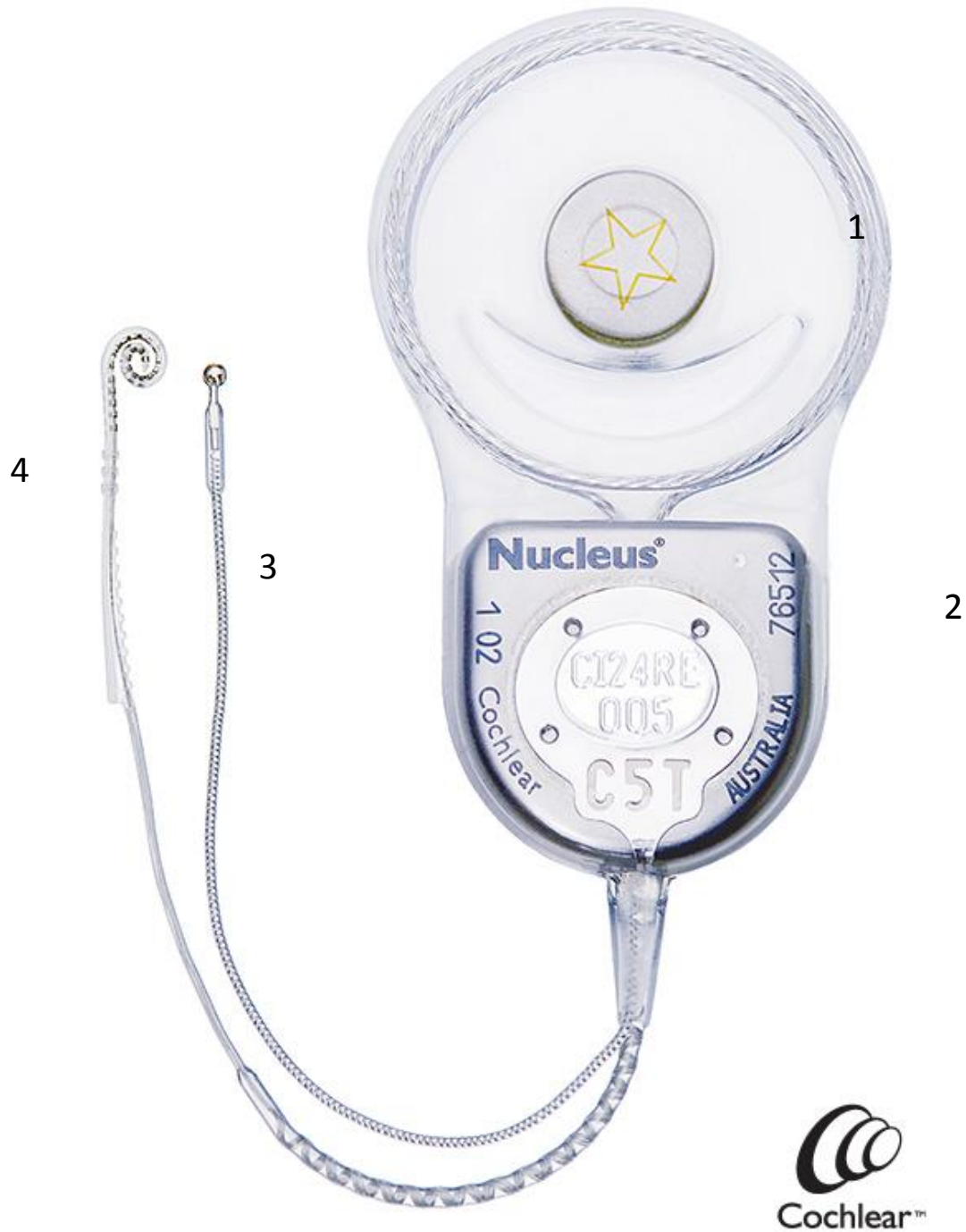
Figura 1.35. Componentes implantables de implante coclear: (1) Antena e imán; (2) Receptor-estimulador; (3) Electrodo extra-coclear ; y (4) Haz de electrodos intracocleares. Imagen tomada de http://la.cochlearamericas.com/
