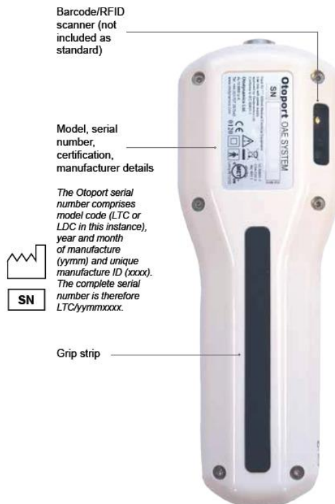
Figura 2.5. Imagen anterior y posterior del instrumento de otoemisiones acústicas Otoport Lite® de Otodynamics.
