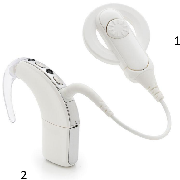
Figura 1.37. Componentes externos del implante coclear: (1) Headset (micrófono, cable y bobina); y (2) Procesador del habla. Imagen tomada de http://la.cochlearamericas.com/
