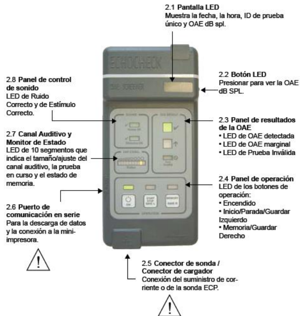
Figura 2.4a. Imagen del instrumento de otoemisiones acústicas ECHO CHECK® de Otodynamics.
