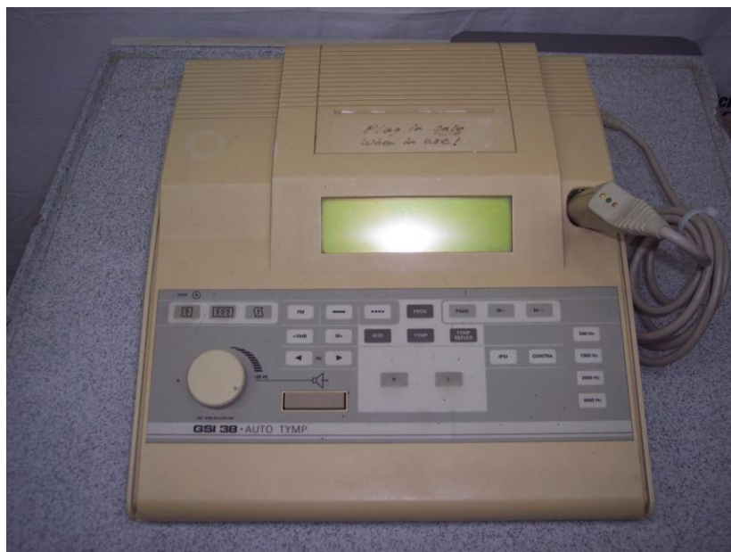
Figura 2.11. Imagen del GSI38 empleado en la impedanciometría.
