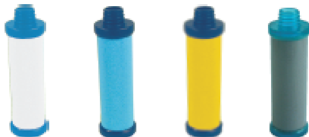
Figura 2.2. Cuerpos difusivos para medida de BTX (blanco y amarillo), \text{NO}_x (azul) y Ozono (negro).
