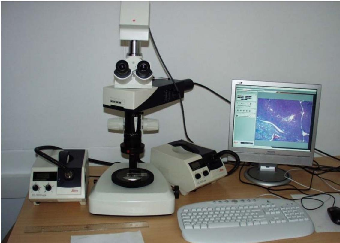
**Fig.36-** -Macroscopio LeicaZ6-APO conectado a cámara digital Leica DC500.
