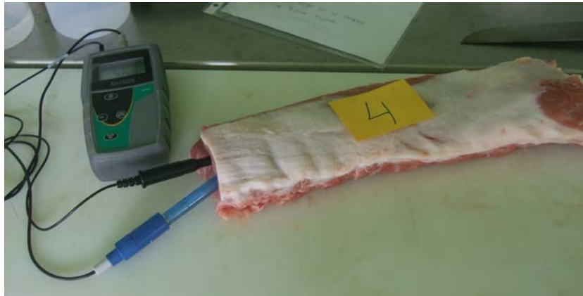
Figura 13. Medida con pHmetro portátil.
