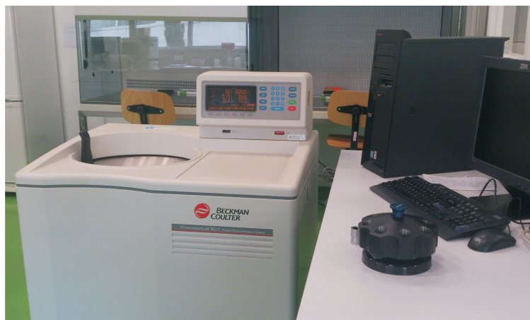
Figura II.3: Ultracentrífuga analítica modelo ProteomeLab™ XL-I de Beckman Coulter (Beckman Coulter, Palo Alto, CA, USA).
