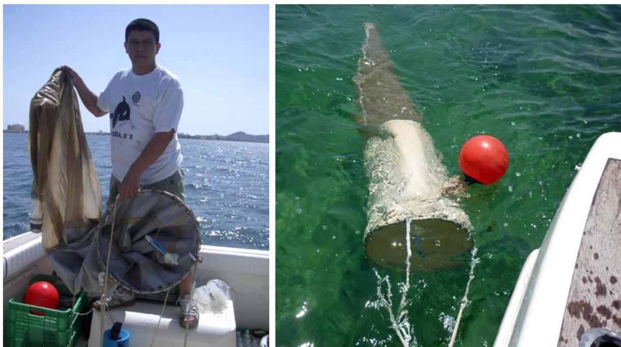
Figura 5. Red de plancton cónica estándar utilizada en los arrastres horizontales realizados en el presente trabajo.
