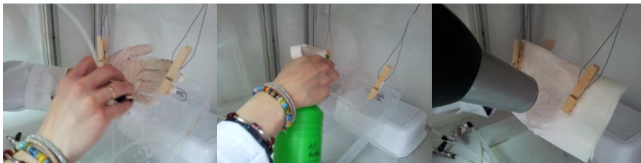
Figura 58: Proceso de pulverización-lavado-secado.
