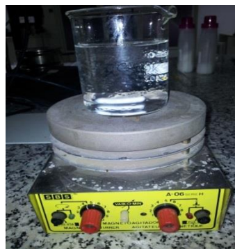
Figura 57: Agitación de disolución de poliacrilamida 0,25 % en peso.
