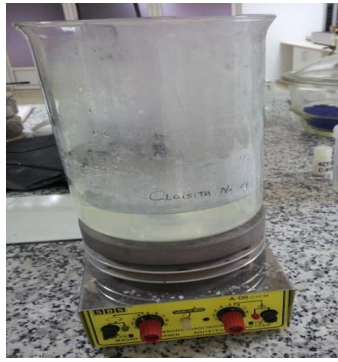
Figura 56: Agitación de disolución de Cloisita Na + 0,2 % en peso.
