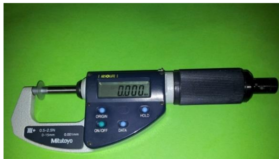
Figura 53: Micrómetro utilizado en la determinación del espesor de los films.
