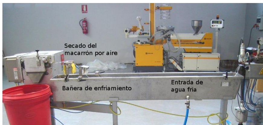
Figura 40: Bañera de enfriamiento.
