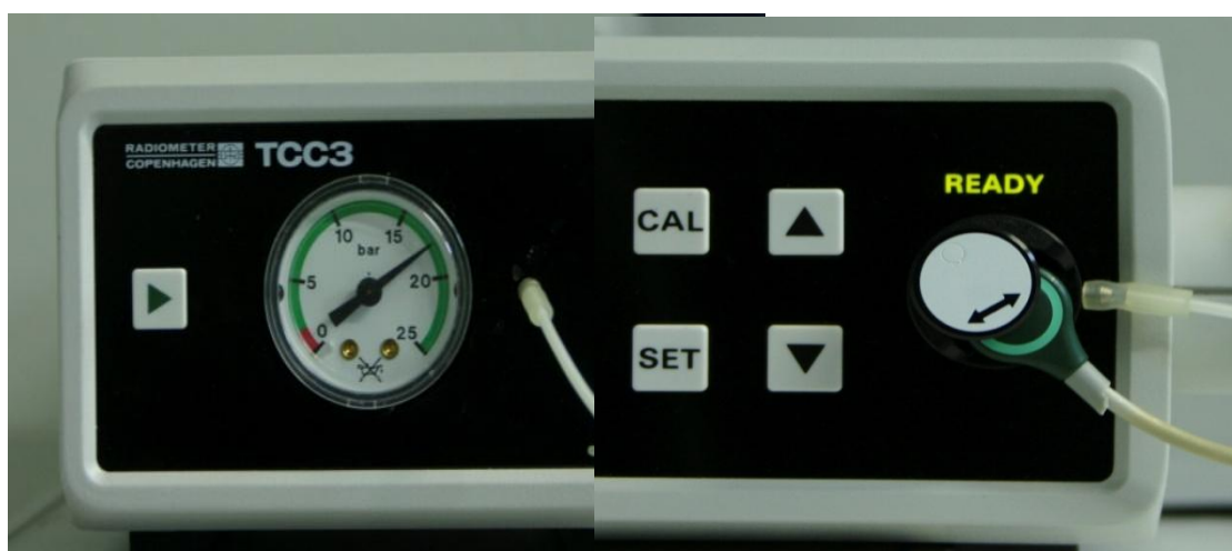
Figura 21. Calibrador de Gases Modelo Radiometer TCC3y monitor de TcpO_2 durante el proceso de calibrado del monitor.
