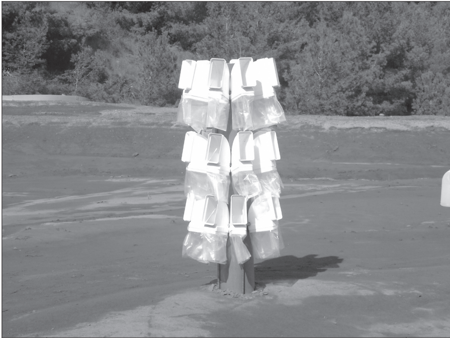
FIGURA 7: Nuevo colector de erosión eólica.
