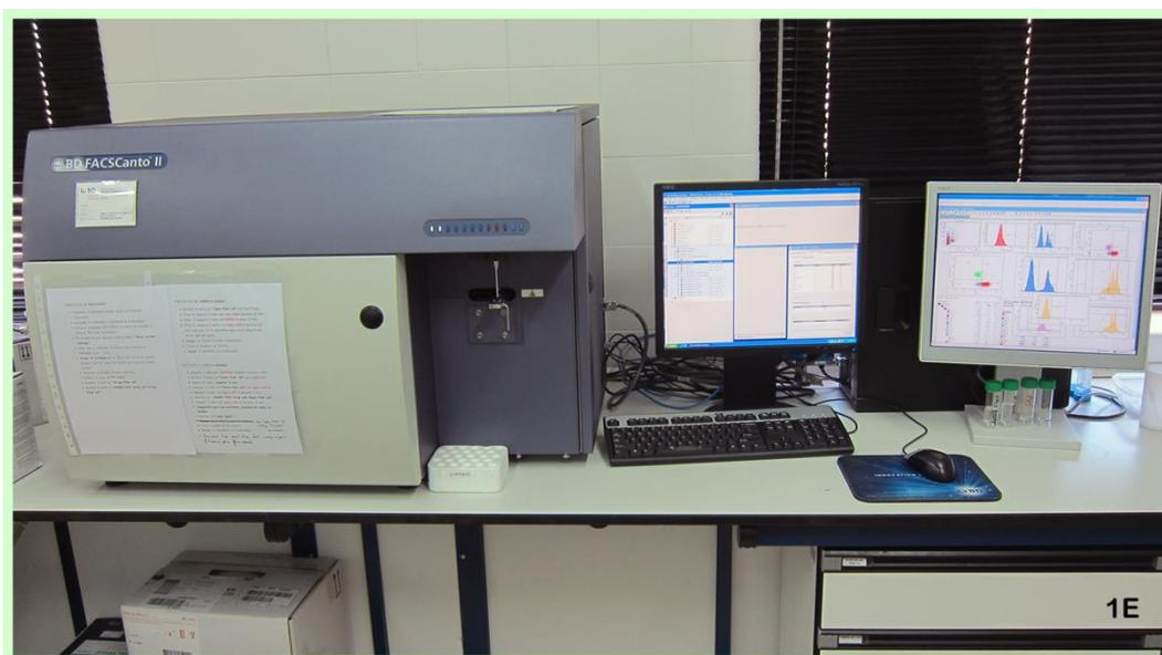
**Figura 1E.** Citómetro de flujo analizador FACSCantoII, Becton Dickinson®
