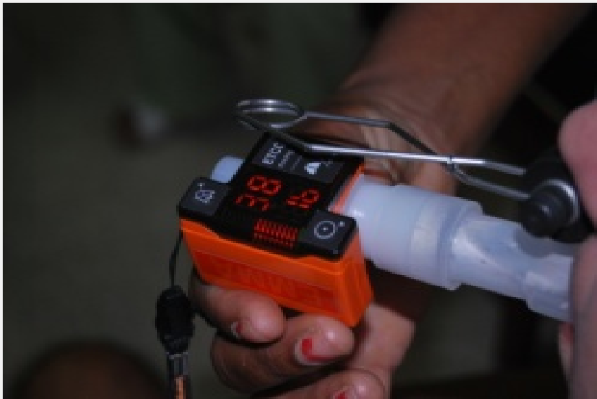
Fig. 2c. Analizador de CO 2 fin de espiración (EMMA) con pipeta bucal
