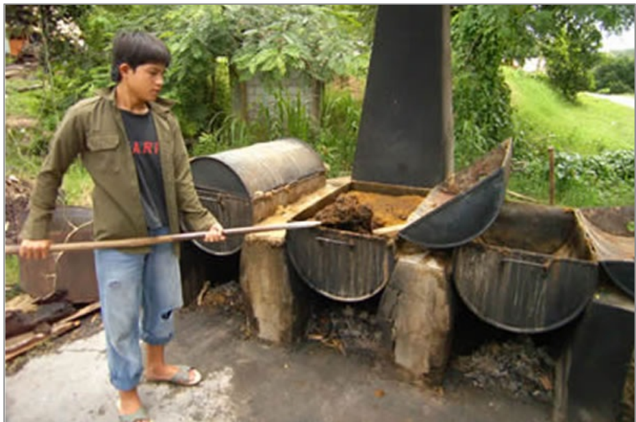
Ilustración 5. Elaboración de pasta de papel con excrementos de elefante. Poor paper (2008)
