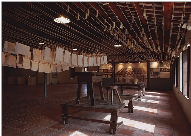
Ilustración 29. Secado de las hojas de papel en un molino tradicional. Capellades (2010)
