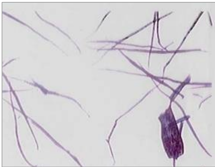
Ilustración 36. Microscopía digital de fibra larga y media de pino. García (2007)
