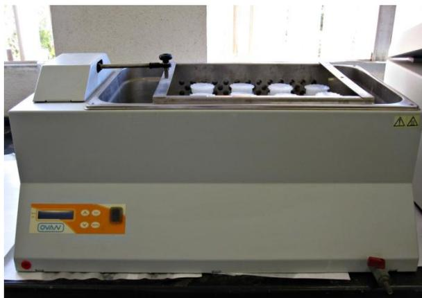
Figura 3. 16.- Baño termostático con agitación.
