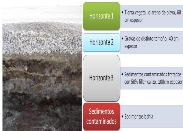
Figura 1. 6.- Diferentes capas de tratamiento del Tecnosol piloto.
