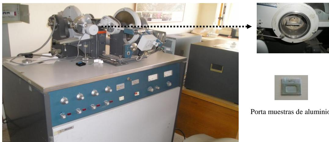
Figura 3. 13.- Difractómetro de Rayos X.
