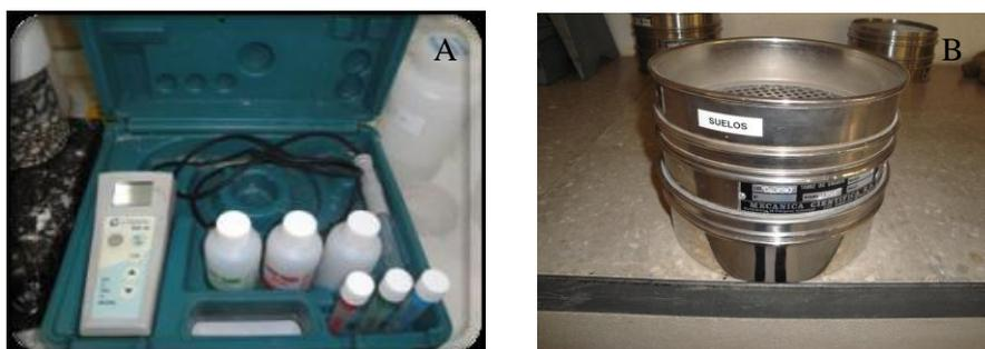
Figura 3. 12.- A) Medidor de pH y conductividad eléctrica y B) Tamiz de 2mm de luz de malla.
