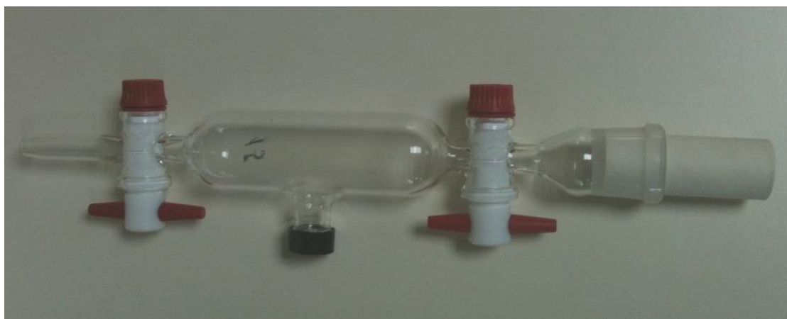
Figura 4.3. Dispositivo de toma de muestra de aire exhalado.
