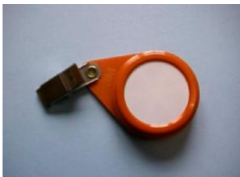
Figura 3.5. Muestreador para vapores orgánicos 3M-3500.
