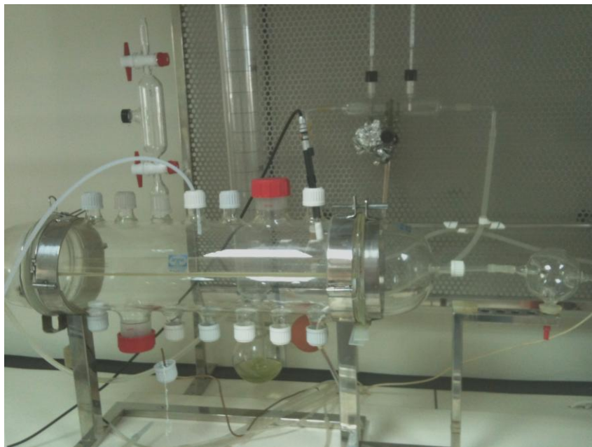
Figura 4.2. Sistema utilizado para generar la atmósfera controlada.
