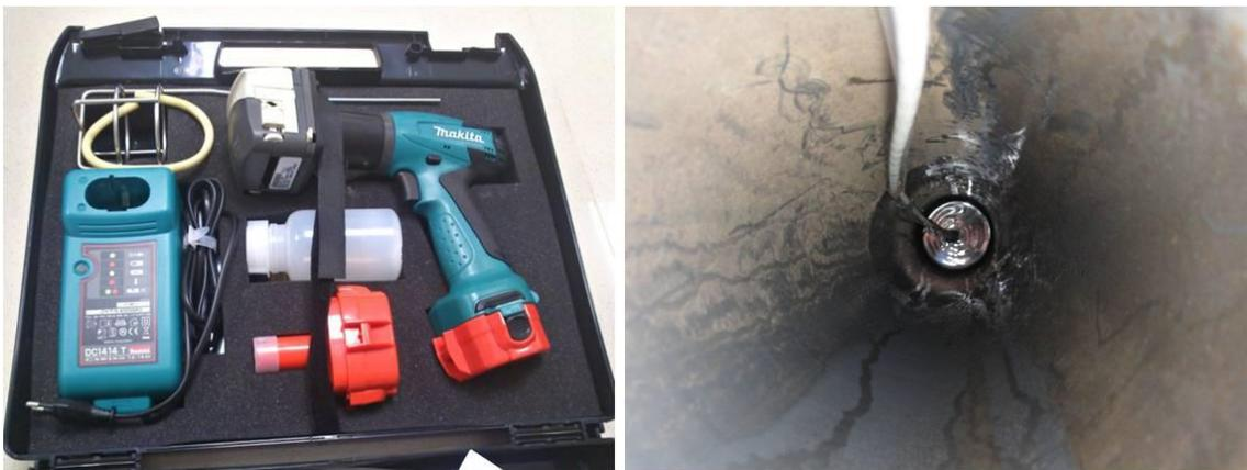
Figura 5. 9. Taladro con bomba peristáltica y extracción de una muestra líquida en uno de los pozos de la barrera.
