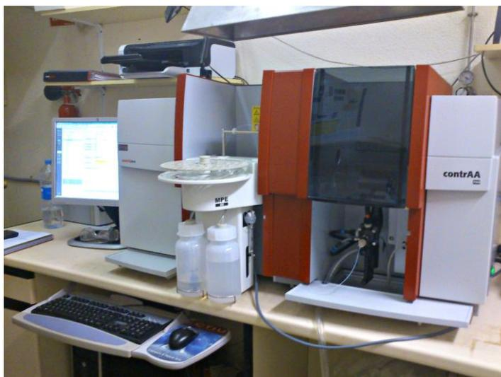
Figura A. 4. Espectrofotómetro de absorción atómica *High Resolution Continuum Source (HR-CS AAS) contraAA® 700*.
