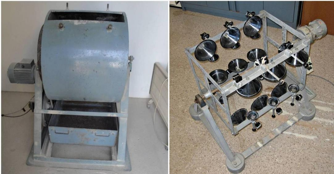
Figura 5. 2. Máquina de “Los Ángeles” y mezcladora.
