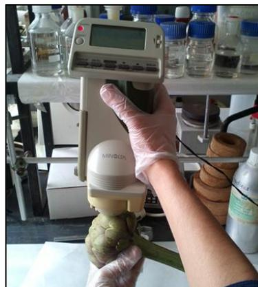
*Fig. 4.1. Medida del color de la alcachofa mediante un espectrofotómetro de reflectancia.*
