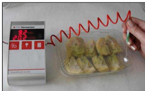
Fig. 4.3. Medidor de atmósfera Checkpoint
