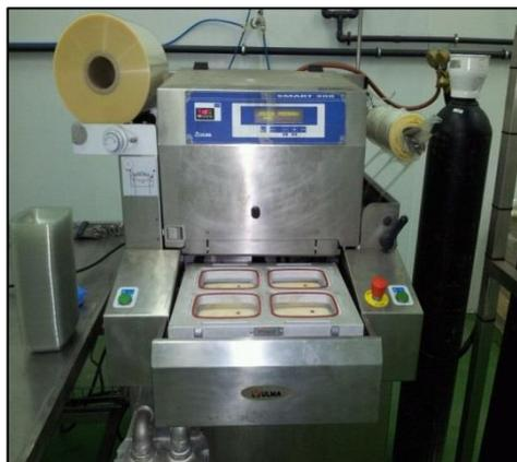
Fig. 5.36. Termoselladora ULMA Smart-300
