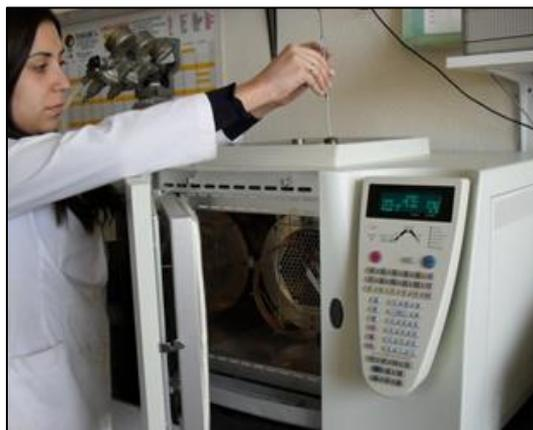
*Fig. 4.2. Cromatógrafo de gases Thermo Trace GC*
