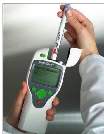
Fig. 5.34. Luminómetro *Clean-Trace NG*
