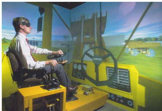
Imagen 5 Simulador para excavadoras
