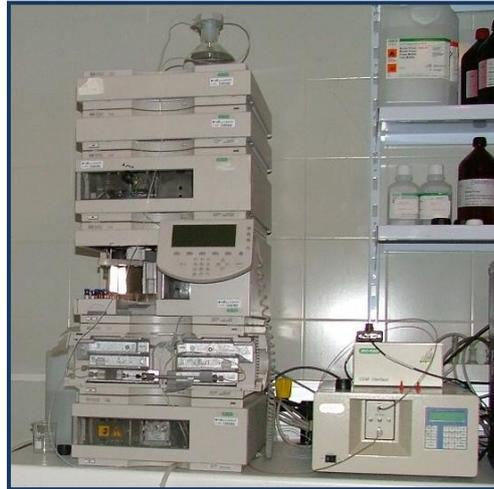
Figura 22. Equipo de cromatografía líquida de alta resolución (HPLC)
