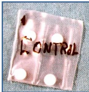
Figura 16. Dosímetros de termoluminiscencia
