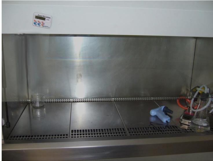
Figura 20. Cabina de flujo laminar
