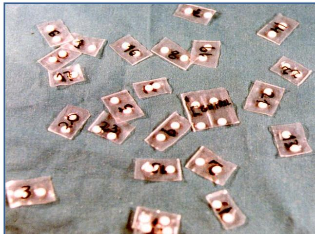
**Figura 24. Dosímetros de termoluminiscencia usados en este estudio.**
