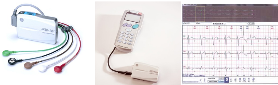
Gráfico 2. Dispositivos Holter SEER y Software registro ECG MARS vs 11.0.
