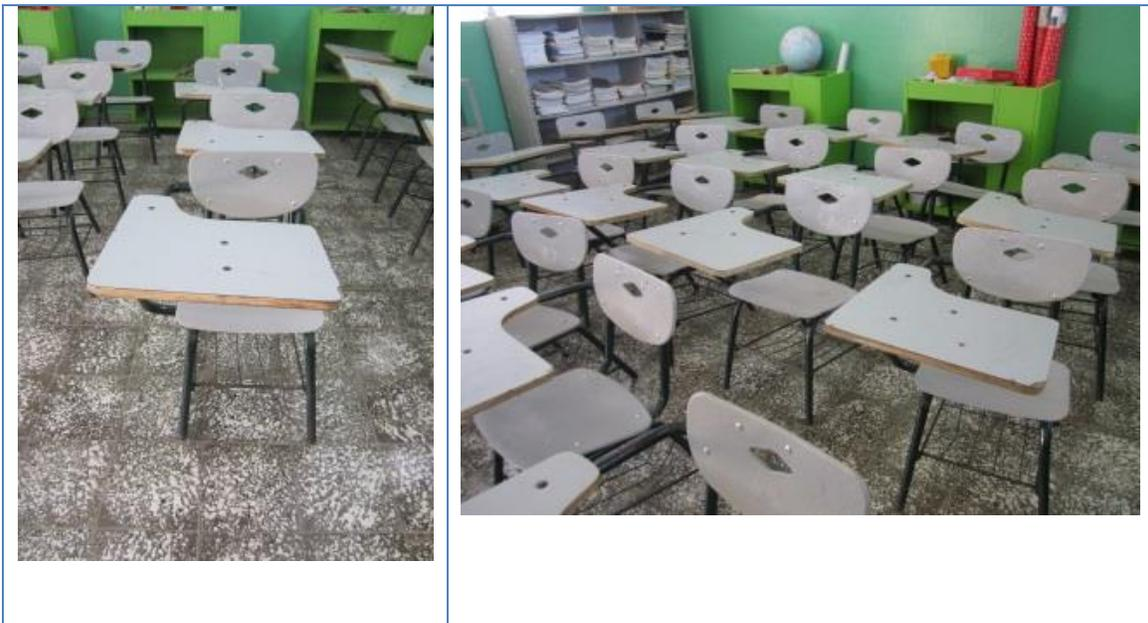
Figuras 5-43 y 5-44. Aulas completas con butacas en muy buena condición, reparadas en polipropileno y tableros laminados, ya pasados cuatro años. Fuente: observación. Noviembre 2011.
