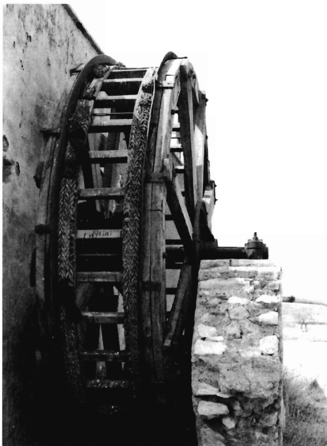
Fig. 2: Detalle de la rueda adosada a la espalda del molino, en ella se aprecia aún la cuerda de esparto o maroma.
