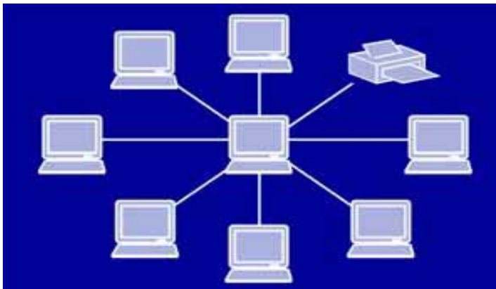
Figura 2.3 – Red conectada en Star o estrella.
