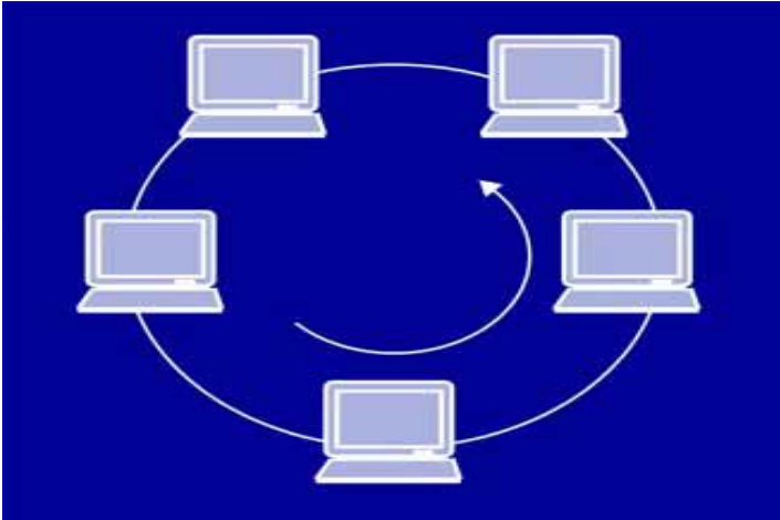
Figura 2.2 – Red conectada en Ring o anillo.
