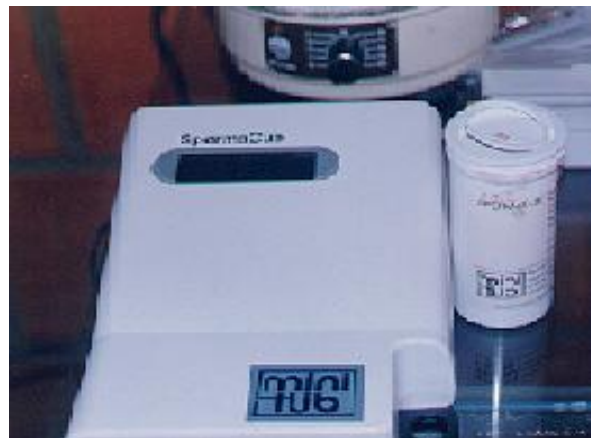
Figura 26. Espectrofotómetro Minitube® para evaluación de concentración espermática en toros.
