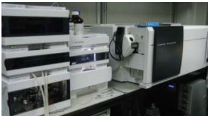
Figura 3.12. Equipo de UHPLC 1290 Infinity acoplado al 6460 triple cuadrupolo (QqQ) (Agilent).
