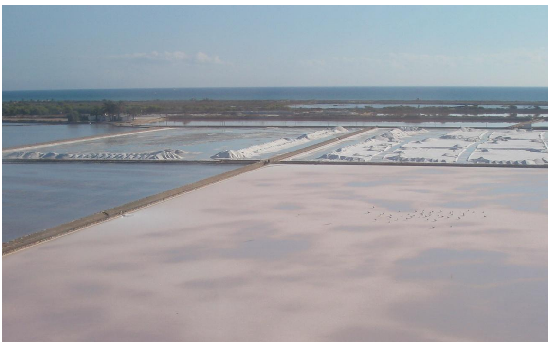
FIGURA 20. Apilado de sal en los estanques cristalizadores de las Salinas de San Pedro para que escurra el agua.
