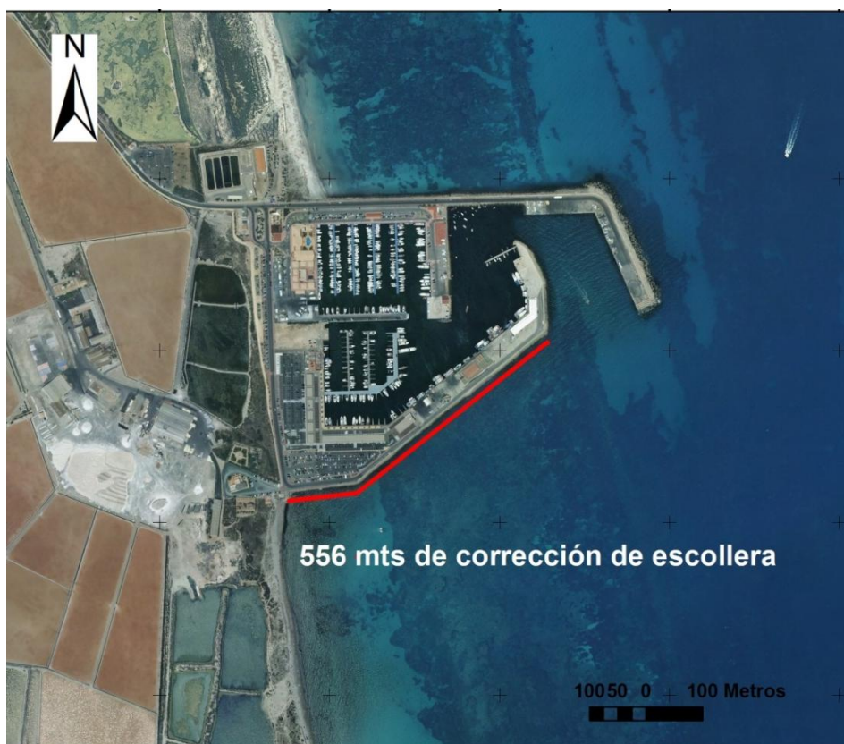
FIGURA 90. Tramo de corrección en el contradique del Puerto de San Pedro. Fuente: AYUNTAMIENTO DE SAN PEDRO DEL PINATAR (2010).
