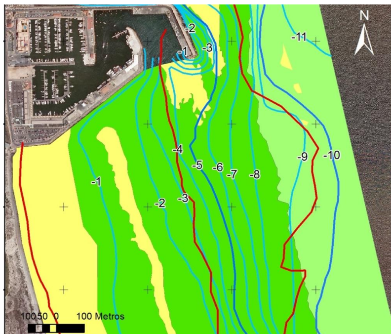
FIGURA 81. Análisis I: Superposición de las líneas batimétricas de la carta náutica 3820 (en rojo), sobre las líneas batimétricas elaboradas por Esgemar (2009).
