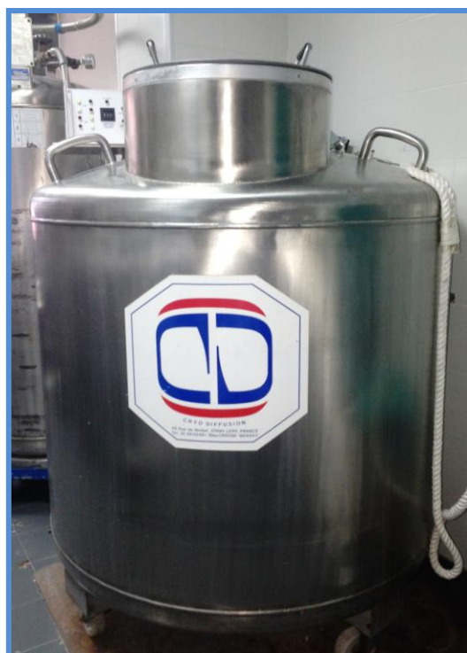
Fig. 15. Tanque de nitrógeno líquido, que mantiene -196^{\circ}\text{C} en la fase líquida y entre -140^{\circ}\text{C} y -196^{\circ}\text{C} en la fase de gas para la conservación de los progenitores hematopoyéticos.
