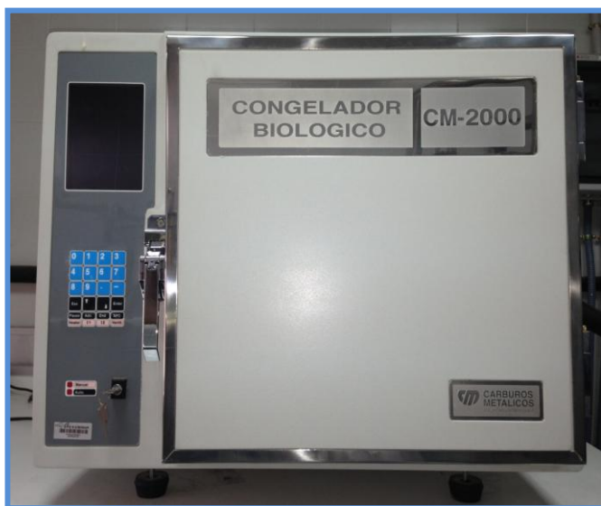
Fig. 14. Congelador biológico que permite la criopreservación de muestras de forma programada.
