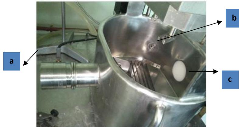
**FIGURA 18.** Instrumentación para la monitorización en línea (a: sensor CoAguLite™; b: sensor LFV; c: cuba experimental).
