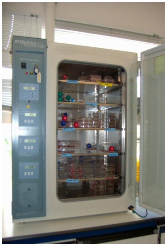
Figura 10: Incubadora a 37°C, con una humedad relativa del 90-95% y en una atmósfera al 95% de oxígeno y 5% de CO 2 .
