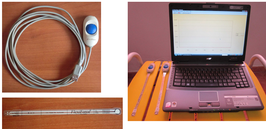
Figura 33. Dispositivo USB ELF, sensor Flexiforce y conexión al ordenador portátil.
