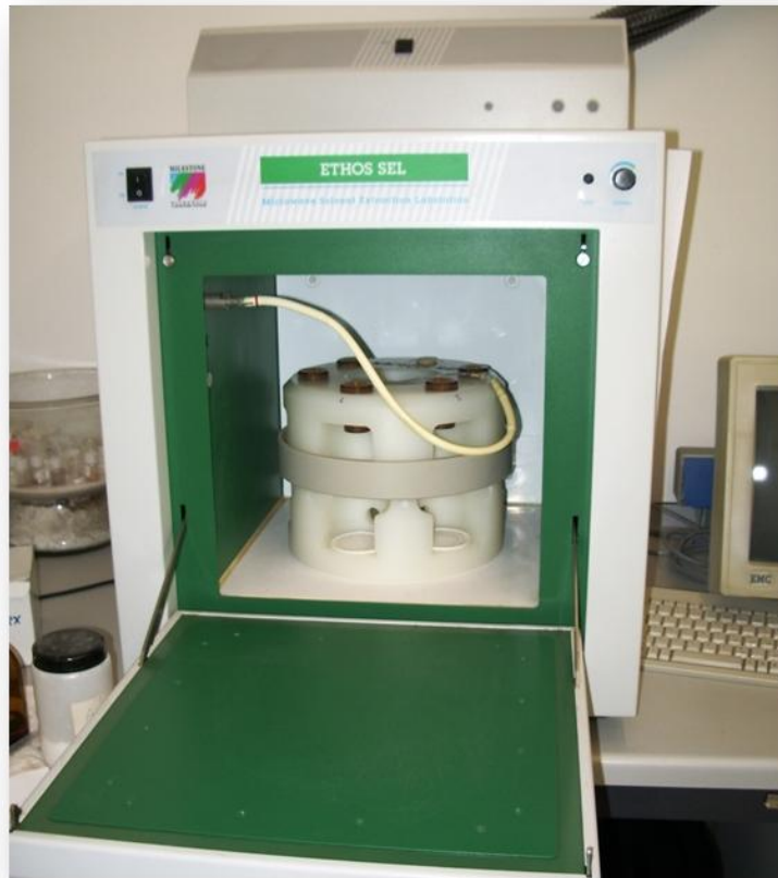
Figura 28. Proceso de digestión en microondas
