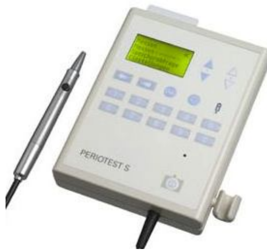
Figura 22. Perio-test ® utilizado para la determinación de la estabilidad de los implantes
