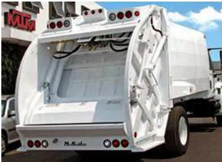
**Fotografía 1. Camión recolector compresor.**
